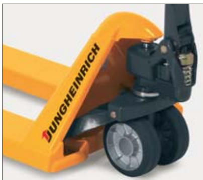
Dlouhodobě mazaná třecí místa umožňují bezúdržbové nasazení
